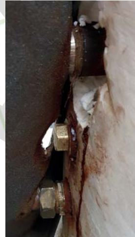
Rézcsővel „kötött” acéltartály csatlakozóinak elektrokémiai korróziója 16 hónap üzemeltetés után, a csatlakozók hegesztési varratainál már első üzemében belül szívárgást okozhat.
