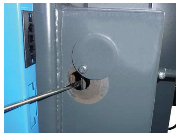
Ellenőrzése és tisztítása a primér és szekunder levegő adagolási pontnak /felső rész/
