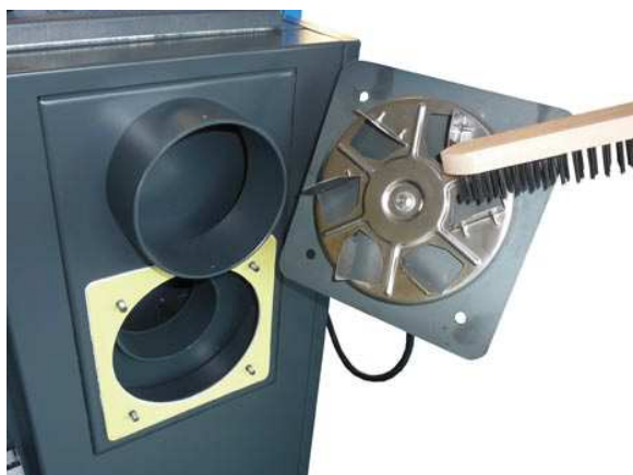
Ellenőrzése és tisztítása keréknek és a lapátoknak a szívó ventilátor
