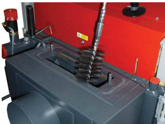
Füstgáz csatorna tisztítása drót kefével /hátl, felső rész/
