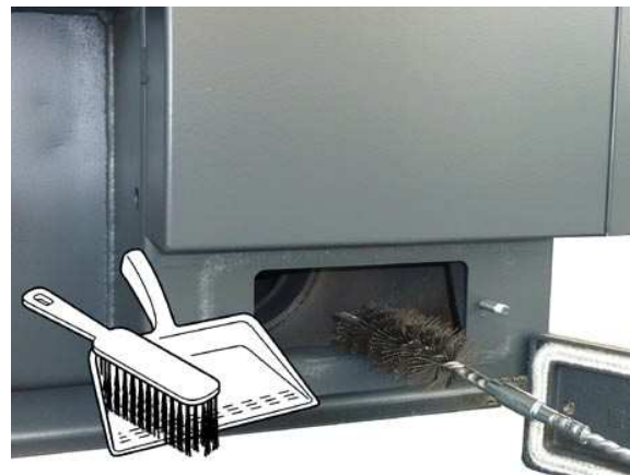
Füstgáz csatorna tisztítása drót kefével /hátl, alsó rész/
