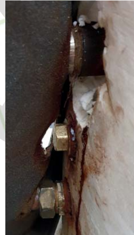
Rézcsővel „kötött” acéltartály csatlakozóinak elektrokémiai korróziója 16 hónap üzemeltetés után, a csatlakozók hegesztési varratainál már első üzemében belül szivárgást okozhat.
